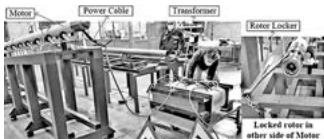
شکل ۲. تست الکتروموتور ۱۳۰ اسب بخار سری ۵۴۰ (طراحی و ساخت جهاد دانشگاهی)
