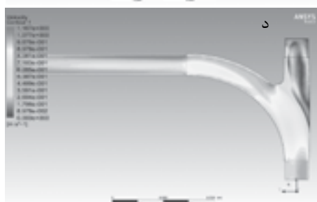
شکل ۱-۳ آنالیز دینامیک سیالات محاسباتی. (الف) شرایط مرزی (ب) مقادیر کمینه و بیشینه فشار (ج) خط جریان (د) سرعت جریان
