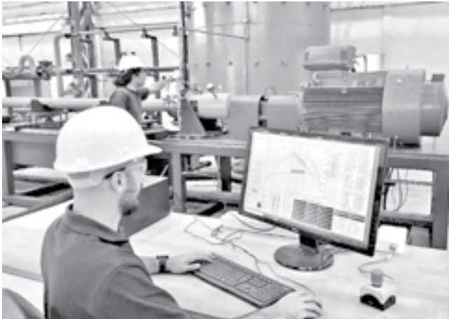
شکل ۶. یک پمپ HPS در حال آزمایش عملکردی بر روی واحد آزمایش پمپ (PTB) کارخانه شرکت پادیاپ تجهیز - اهواز
