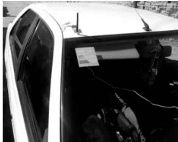
تصویر آنتن و سیستم رادیویی نصب بر روی خودرو
