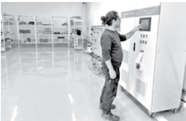
شکل ۷. یک نمونه فرکانس درایو متغیر در حال تست در واحد Electric Shop کارخانه شرکت پادیاپ تجهیز - اهواز
