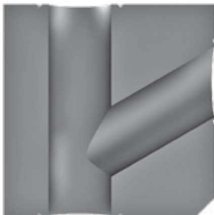
شکل ۱-۴. نمای برش خورده از طراحی جدید خم تولید
