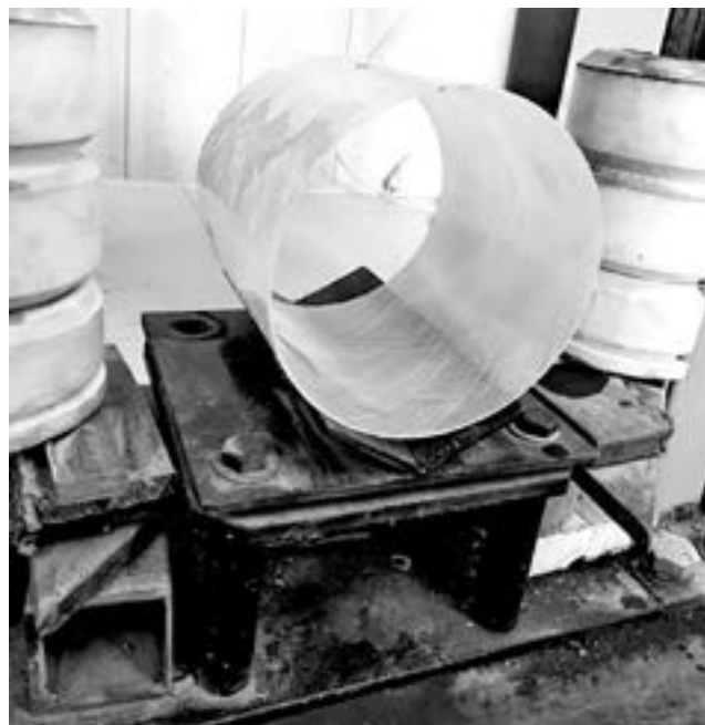
شکل ۲: نمونه بر روی فیکسچر
