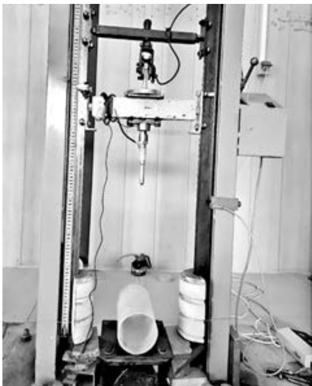
شکل ۳: دستگاه آزمایش ضربه به همراه تجهیزات اندازه گیری آماده تست
